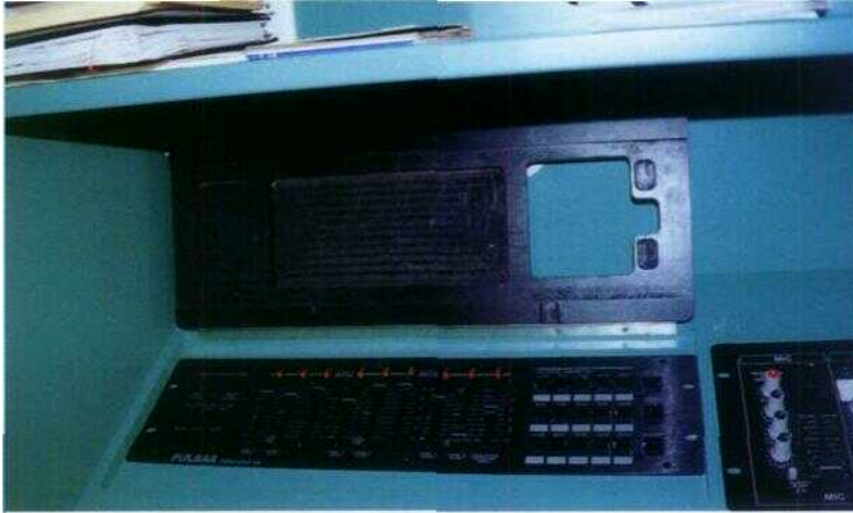
Pulsar Minipiece 54 Lichtsteuerung mit aufgeklappter Abdeckung
